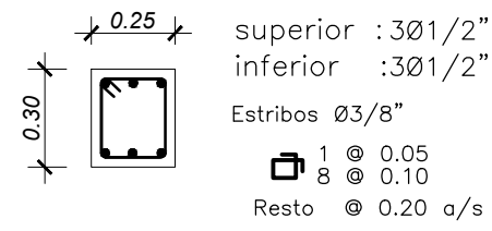
Sección h-h V-103 (0.25 x 0.25) Esc. 1/25
